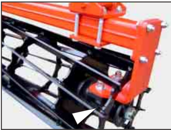
Mancais dos rolos compactadores.
