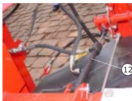
Acionamento hidráulico por cilindros de dupla ação (12) - (Opcional)
