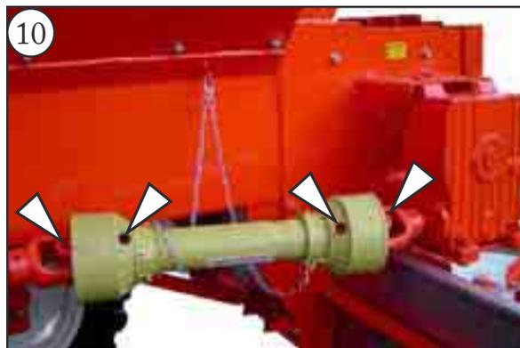
10 - Eixos cardan lateral: 1 ponto em cada ponta das capas de proteção.
