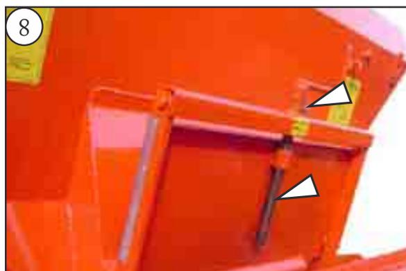
8 - Manivela da tampa de regulação de fluxo: 1 ponto, e aplique graxa com um pincel na rosca do fuso.
