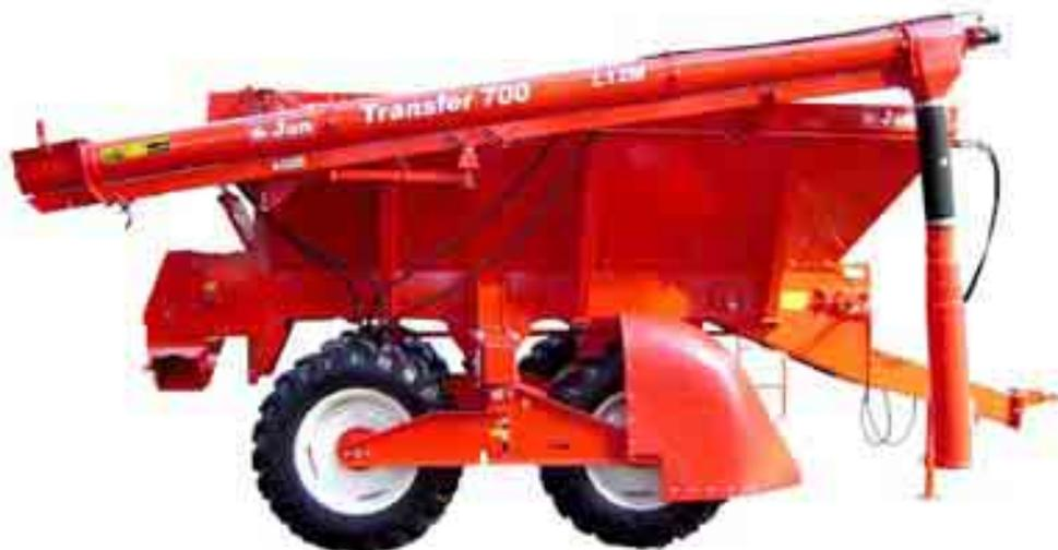
O acessório Transfer 700 acoplado ao Lancer 12.000 Multiuso destina-se ao abastecimento de fertilizantes em plantadoras / semeadoras e a descarga em moegas.
