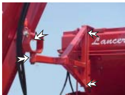
Quatro graxeiras nos mancais dos suportes de articulação.
