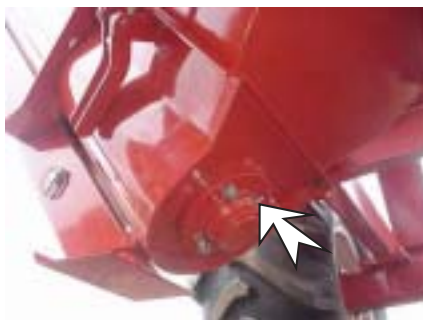
Uma graxeira no mancal inferior do helicóide transportador.
