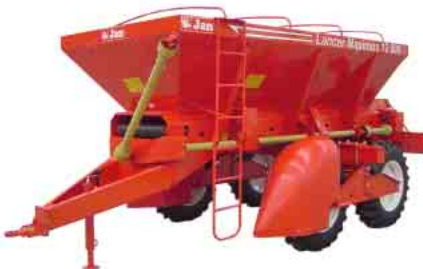
○ distribuidor Lancer Maximus 12.000 destina-se a distribuição, com precisão, de adubos, sementes, calcário úmido ou seco e gesso.
