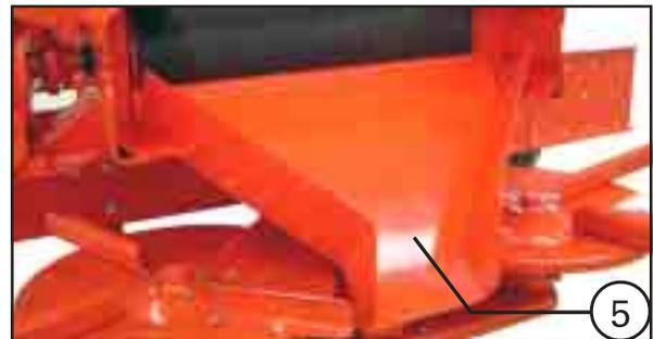
Funil para medição de vazão: calibra o Lancer para uma perfeita dosagem.
