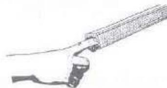
Fig. 10 - Lubrificação do tubo do cardan.
