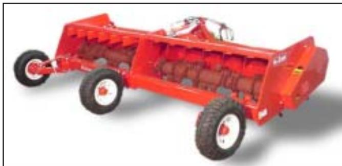
O Tritton é equipado com facas rotativas, destinado a trituração dos restos de cultura, como palha de milho, trigo, fumo, girassol e na derrubada de pastagens como aveia e gramíneas, leguminosas de cobertura e para reformas de canaviais.
