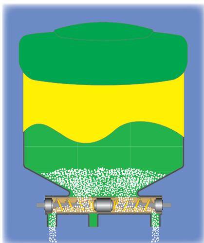
A distribuição de adubo através de Condutoras Helicoidais (Sem Fim) proporciona maior precisão e uniformidade. Os mexedores auxiliam a distribuição evitando paradas.
