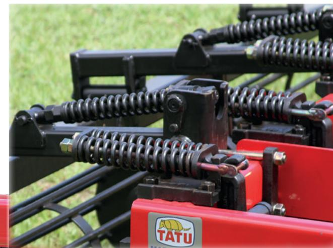
O sistema de segurança com molas helicoidais proporciona o desarme da haste perante obstáculos, sem uso de pinos fusíveis. Para voltar à posição normal basta um curto movimento de marcha-à-ré.
