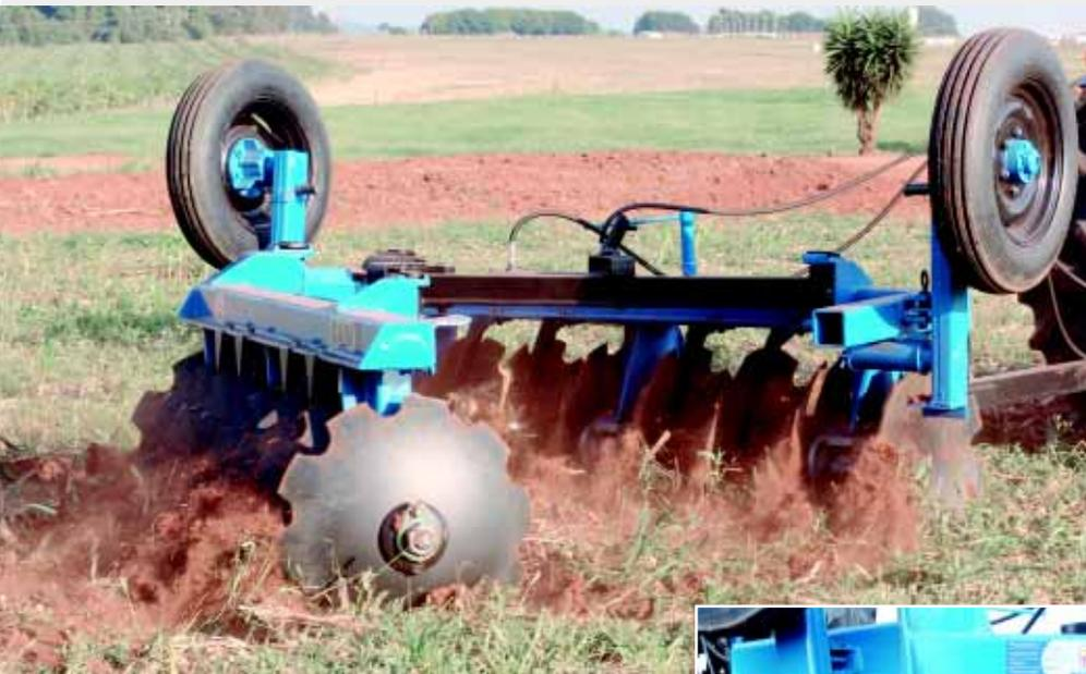
**Discos:** recortados de alta resistência ao desgaste e aos impactos.
