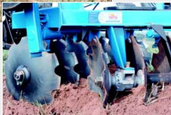
**Mancais** com dois rolamentos de rolos cônicos, lubrificados a graxa (CM) ou em banho de óleo permanente - DUROMARK® (DM).
