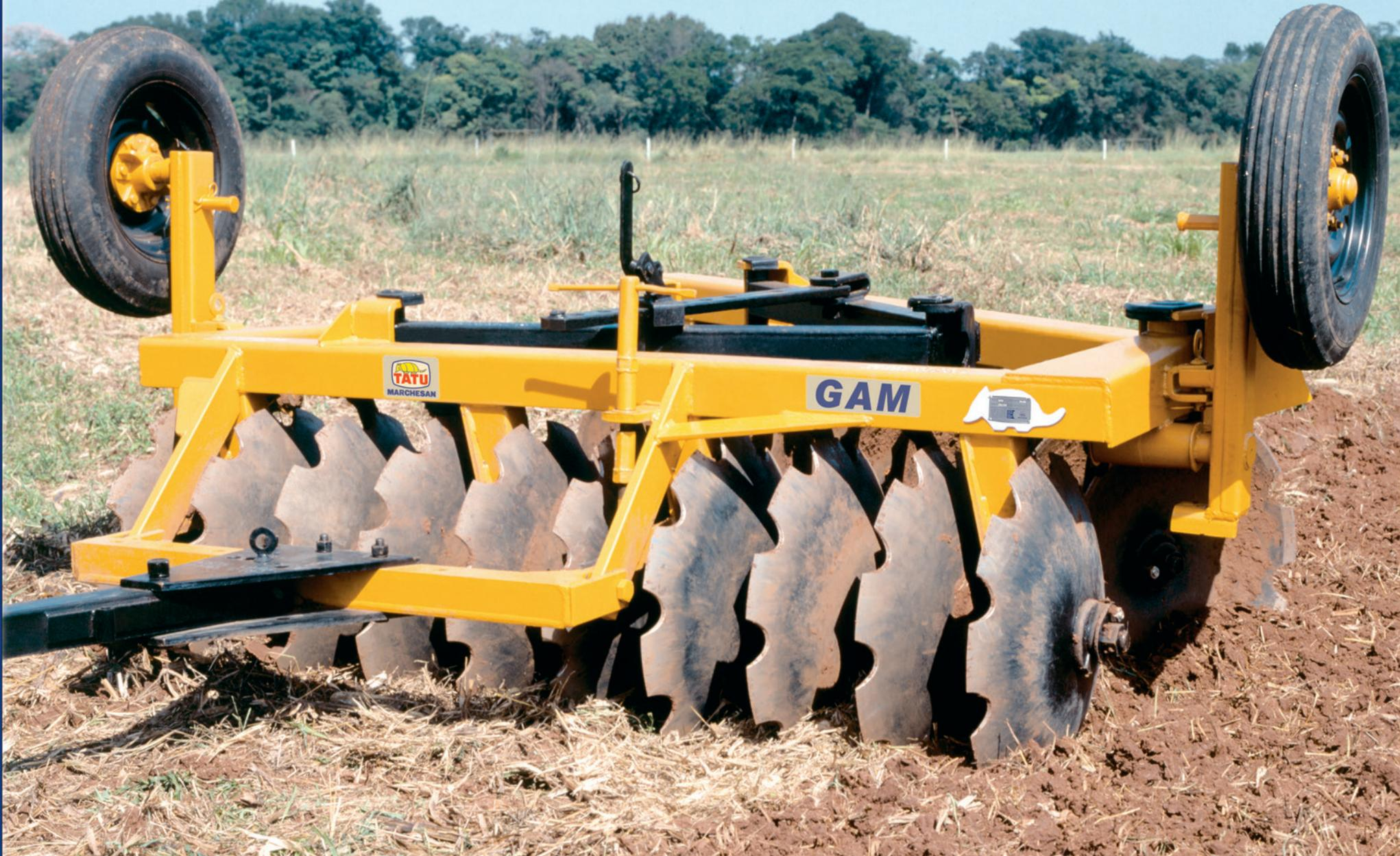
A **GAM** é utilizada no preparo do solo em geral, ou no destorroamento, após o uso de grades de maior porte.
