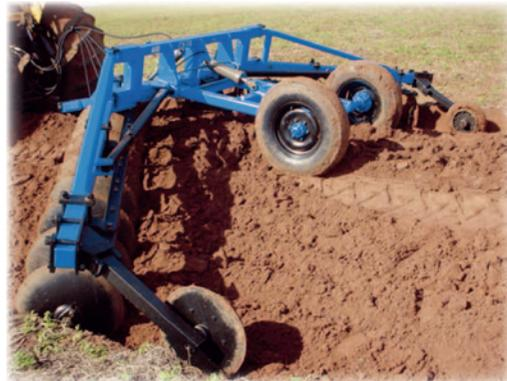
Construindo em média de 600 a 800 metros de terraço por hora, o uso do TSTA permite manter a camada fértil do solo, com aproveitamento total da área para o plantio.
