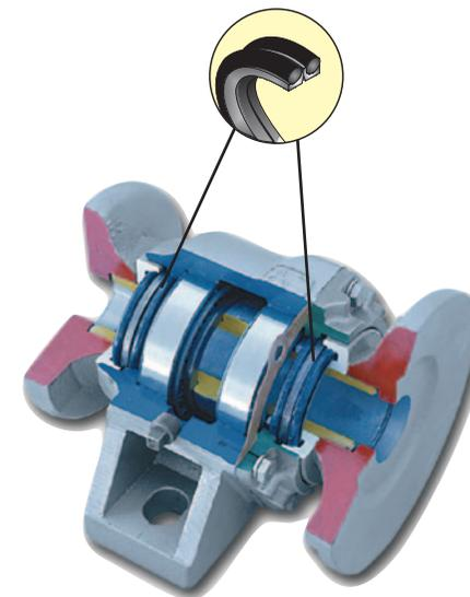
**Mancais** com dois rolamentos de rolos cônicos, lubrificados a graxa (CM) ou em banho de óleo permanente - DUROMARK® (DM).
