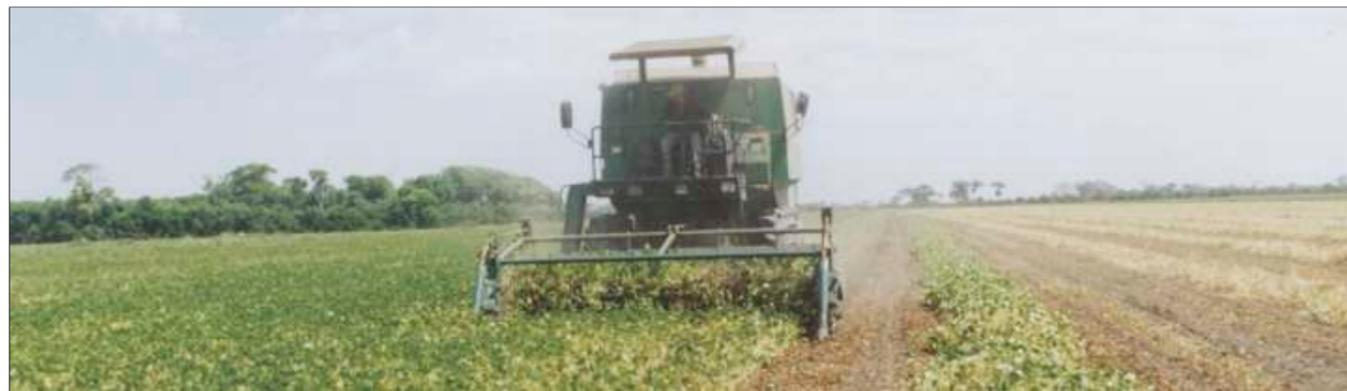
O **CEIFLEX** pode ser acoplado a diversos modelos e marcas de colhedoras automotrizes. Possui sistema hidráulico independente (não interfere no funcionamento da automotriz) composto por reservatório hidráulico com sistema de refrigeração (trocaador de calor ar/óleo), filtro de linha e bomba para acionamento dos motores hidráulicos.
