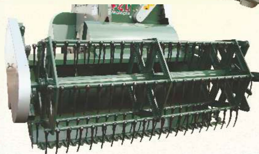
Plataforma de corte com 2.200 mm de largura para colheita de soja e feijão. Acionada mecanicamente.
