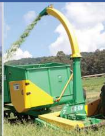
▶ C120 S2 ACOPLADA A UMA PLATAFORMA JF 1300 S2* ÁREA TOTAL DE 1.3 m / COLHE E PICA O CAPIM VERDE / RECOLHE E PICA O PRÉ-SECADO
