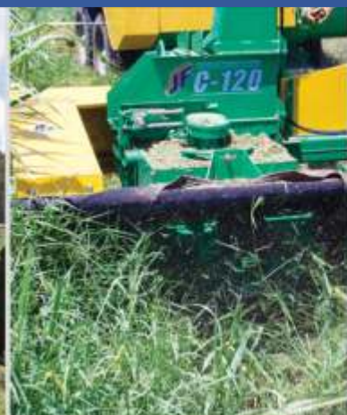
▶ C120 S2 ACOPLADA A UMA PLATAFORMA JF 1300 S2* ÁREA TOTAL DE 1.3 m / COLHE E PICA O CAPIM VERDE / RECOLHE E PICA O PRÉ-SECADO
